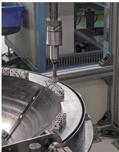
▲ 円弧トラッキング（ロボット追従エリア）
